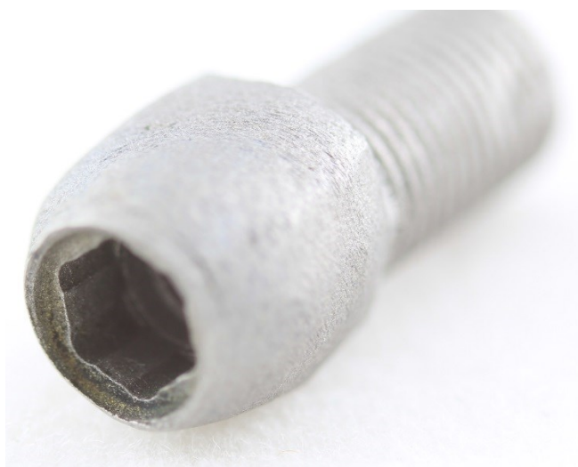
Figura 3: Elemento fundido após a desinclusão e pronto para realização dos testes de liberdade rotacional
