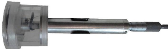
**Figura 8: Fotografia da câmara de ionização de extrapolação caracterizada neste trabalho [NEVES *et al.* (2012)].**
