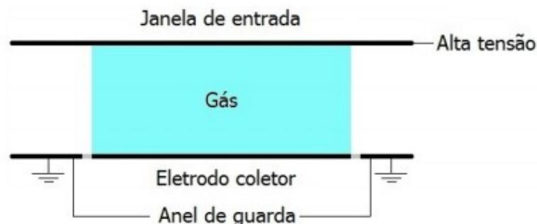
**Figura 4: Representação esquemática de uma câmara de ionização de placas paralelas [YOSHIZUMI (2010)].**
