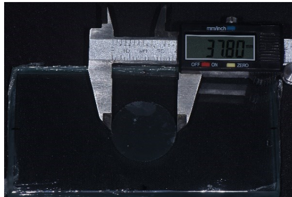
Figura 5: Medição da área circunferência com parquímetro digital, após a fotopolimerização.
