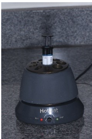
Figura 2: Cimento inserido no dispositivo de pré-aquecimento Hotset®.
